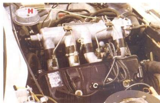
Injectiemotor van de Peugeot 504 Coupé met spruitstuk en injectoren. Linksboven de hoogtedrager (H) voor het injectiesysteem
