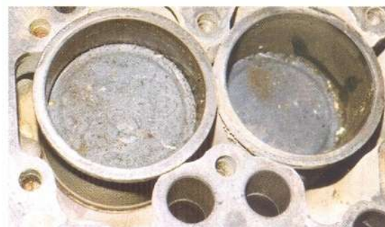
Versleten losse cilinderbussen zijn eenvoudig door nieuwe te vervangen
